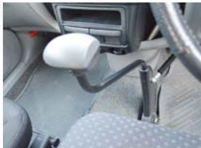
前に倒すとアクセル、後ろがブレーキ
