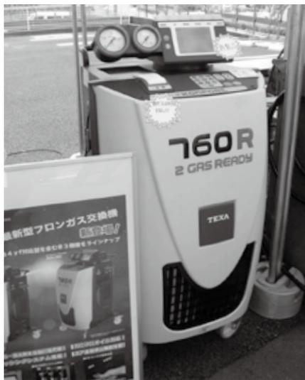
新型ガスに対応したフロンガス交換機
