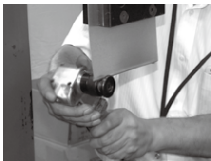
最新車種で増えてきた、クォーターパネルのホイールアーチ部の折り曲げ加工に最適なヘミングツール
