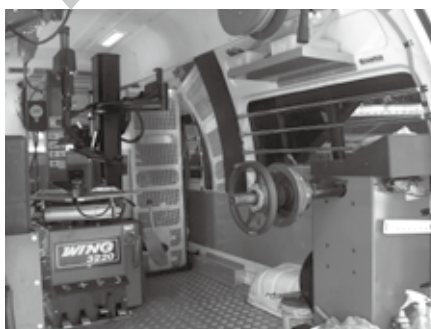
各種タイヤ機器はもちろん、リチウムイオンバッテリーも搭載し、最長2時間の作業に対応
